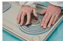
3. Cada placa de retenção deve ser plana e não desigual ou dentada ao longo do perímetro. O filtro deve estar presente, cobrindo cada orifício perfurado de ventilação. A placa de retenção deve estar bem fechada quando premida para baixo no ponto central. Se a placa de retenção não estiver bem fechada, o filtro e a placa de retenção podem cair no conteúdo do Recipiente, comprometendo a carga.
