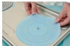
Забележка: Хартиените филтри трябва да се използват само при парна стерилизация и стерилизация с етиленоксид (EO). Нетъканите филтри от полипропилен трябва да се използват за стерилизация с H2O2, STERRAD, STERIZONE и V-Pro и може да се използват при парна стерилизация с форвакум и стерилизация с EO.
