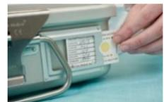
10. SteriTite-Container wurden so konzipiert, dass sie nach der Sterilisation trocken sind. Absorbierende Tablettts werden in Verbindung mit SteriTite®-Containern daher nicht empfohlen.
