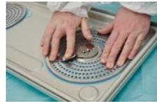
2. 蓋とフィルター保持プレートのガスケットが割れたり裂けたりせずに柔軟であること、それらがすべて正しくしっかりと固定されていることを確認してください。
