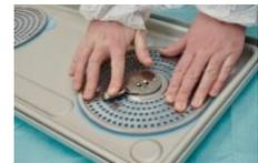
2. Verifique se as juntas na tampa e na(s) placa(s) de retenção são maleáveis, se não apresentam fissuras ou rasgões e se estão todas devida e firmemente encaixadas.
